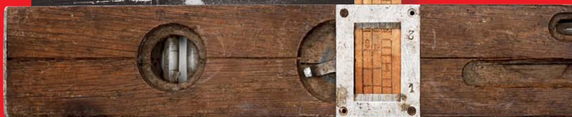
1949 — vodováha se sklonoměrem NT4 ze dřeva
